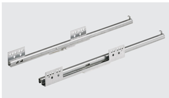
Quadro 25 Stop Control Частичное выдвижение со встроенной функцией самозакрывания Нагрузочная способность 25 кг
