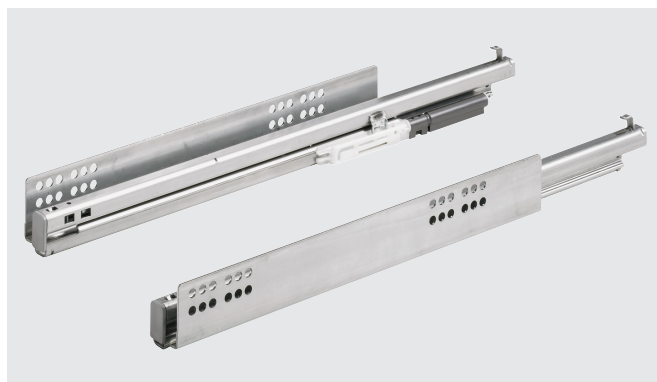
Quadro V6+ Silent System Полное выдвижение с интегрированным демпфированием Нагрузочная способность 50 кг
